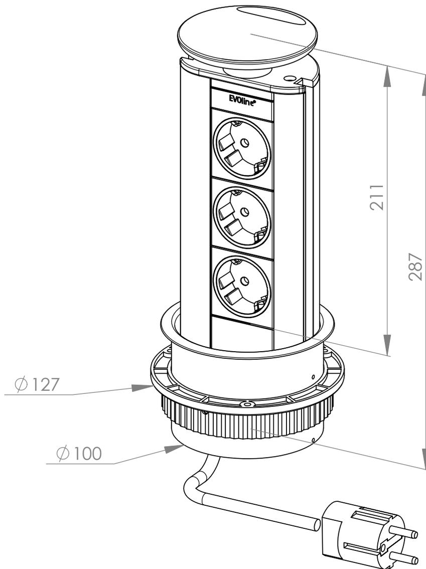
Einbaubohrung  $\phi$  102 mm
