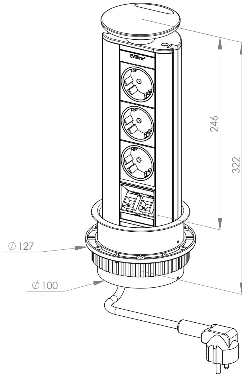
Einbaubohrung  $\varnothing 102$  mm
