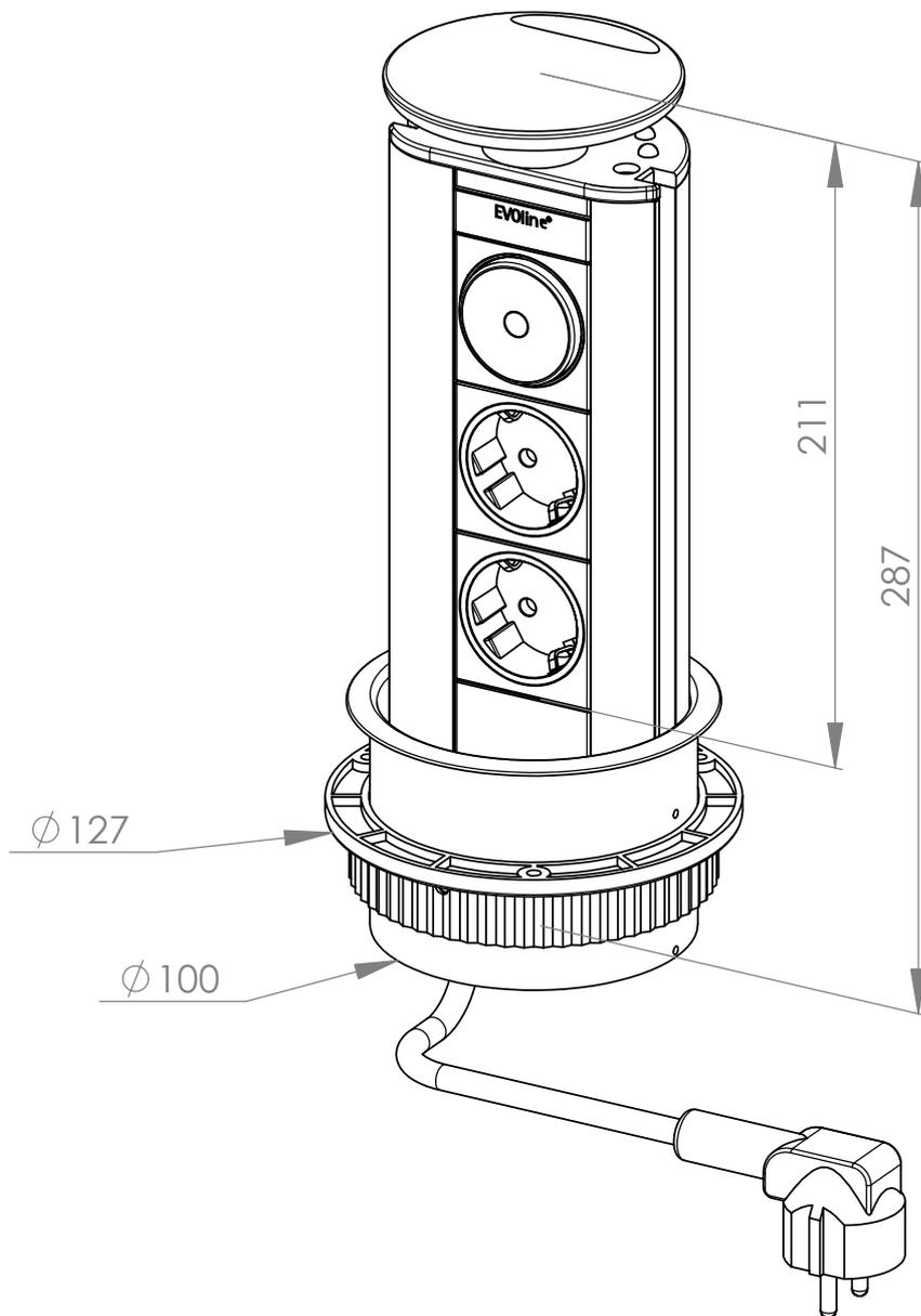
Einbaubohrung  $\varnothing 102$  mm
