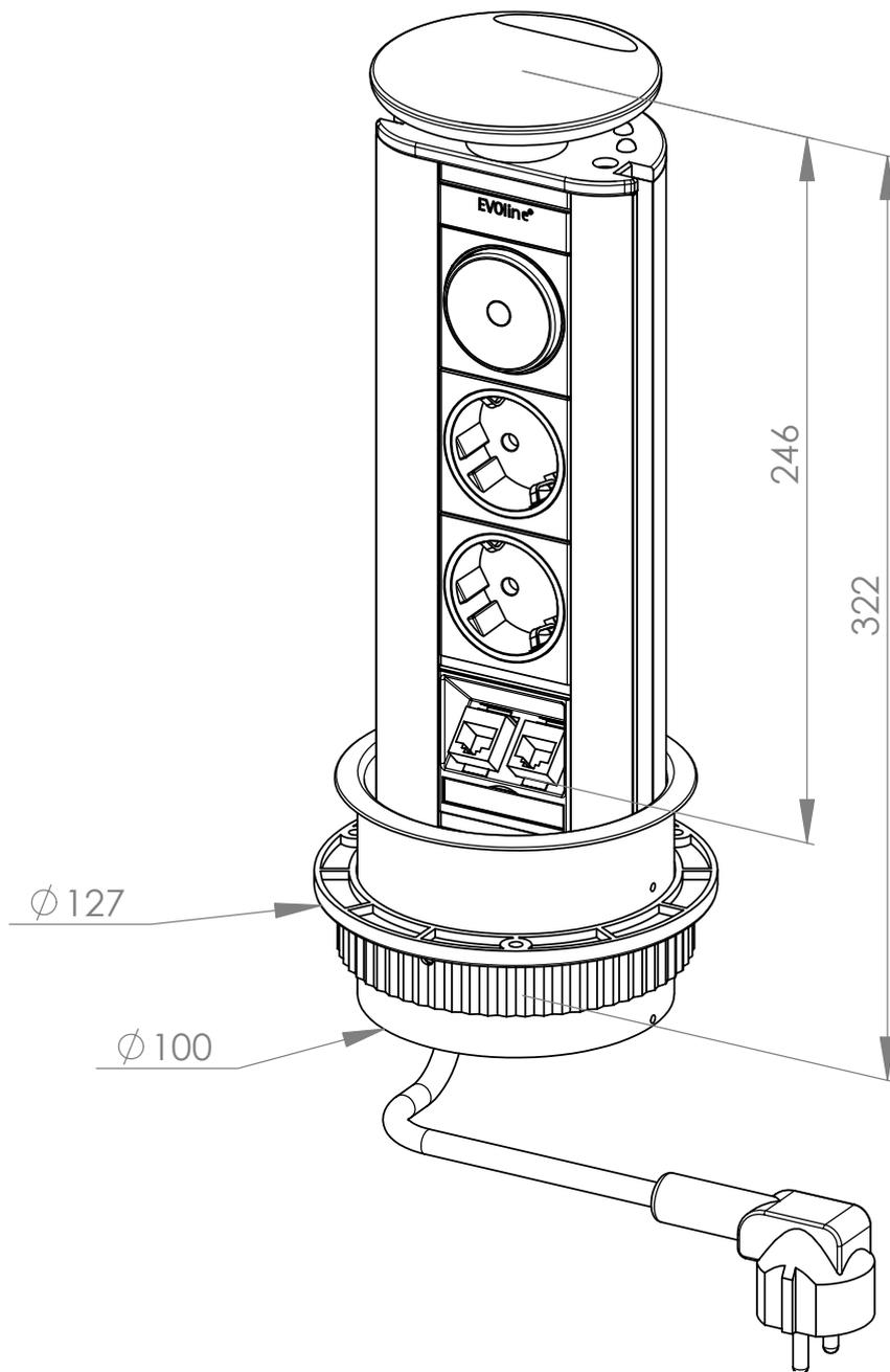
Einbaubohrung  $\varnothing 102$  mm
