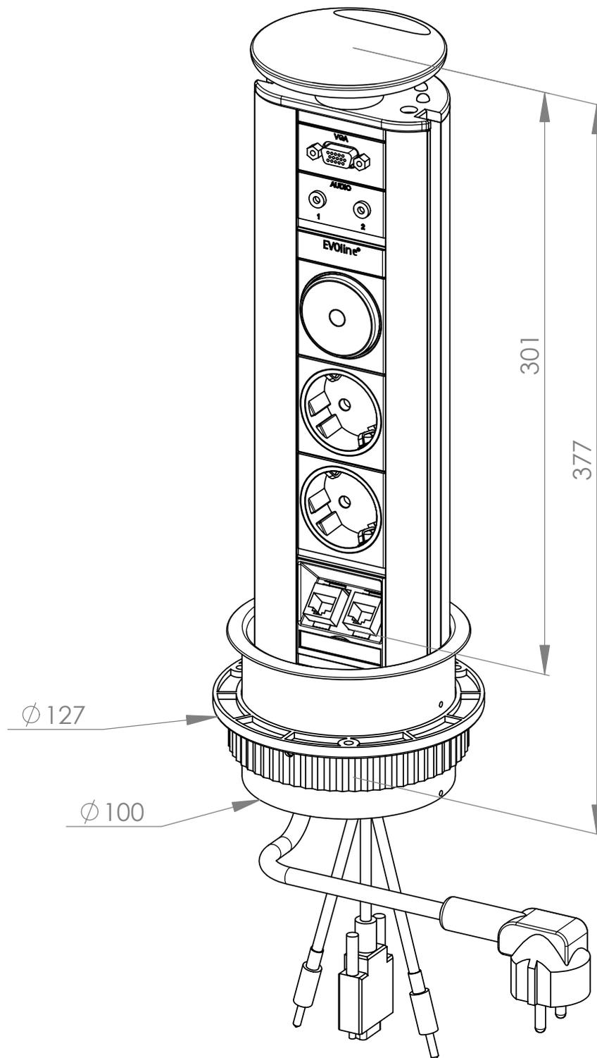
Einbaubohrung  $\varnothing 102$  mm
