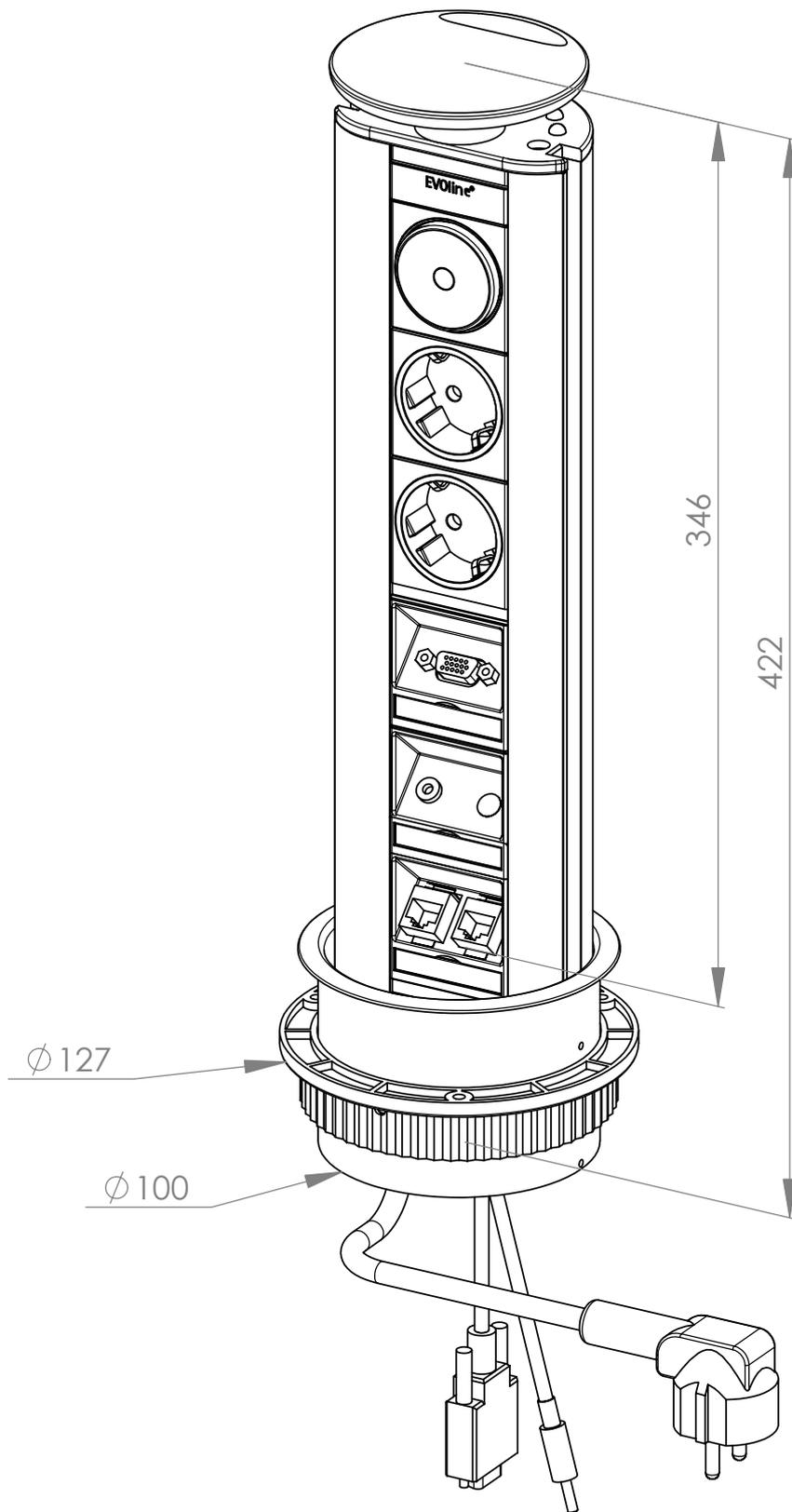
Einbaubohrung  $\varnothing 102$  mm
