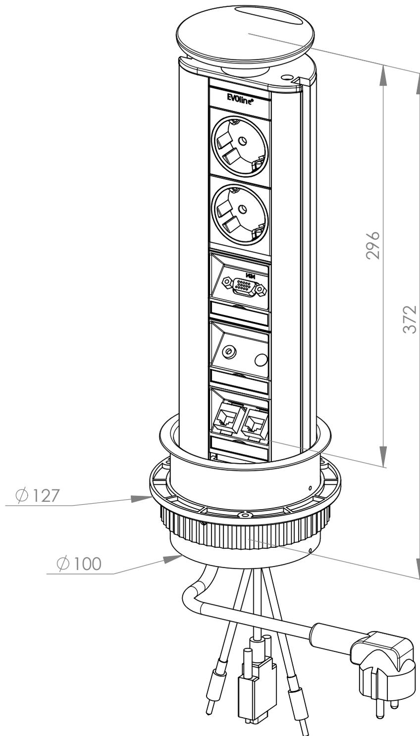
Einbaubohrung  $\varnothing$  102 mm
