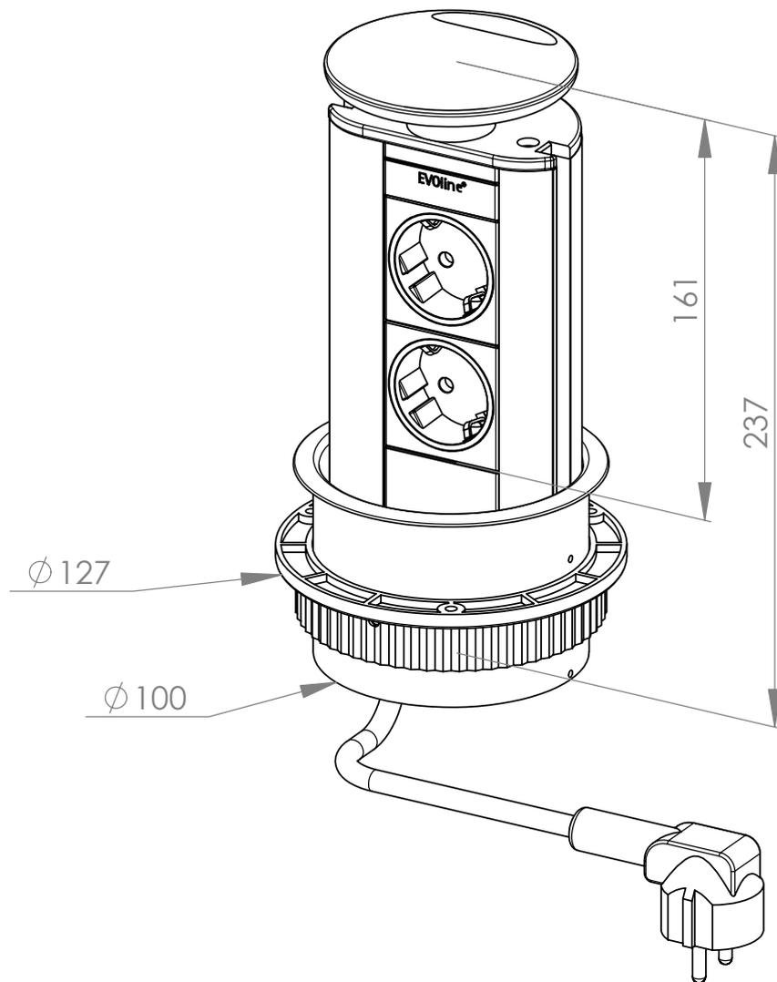
Einbaubohrung  $\varnothing 102$  mm
