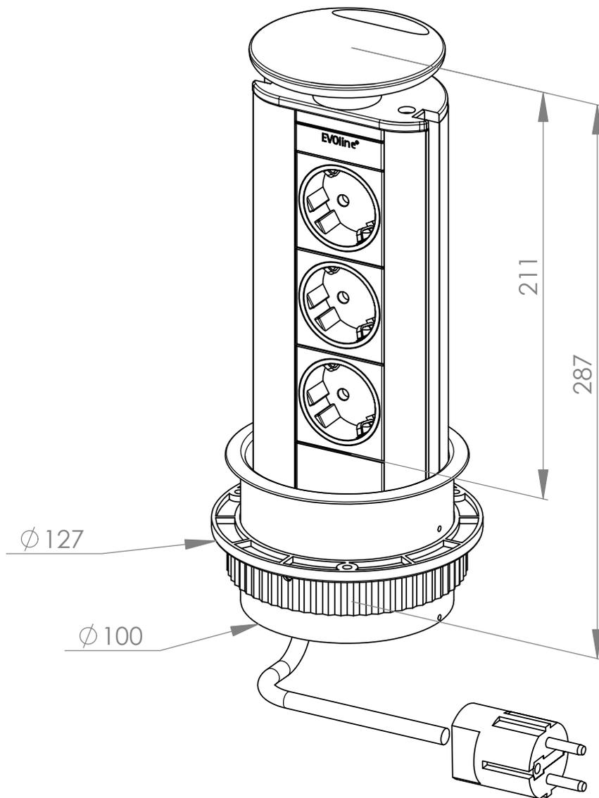
Einbaubohrung  $\varnothing 102$  mm
