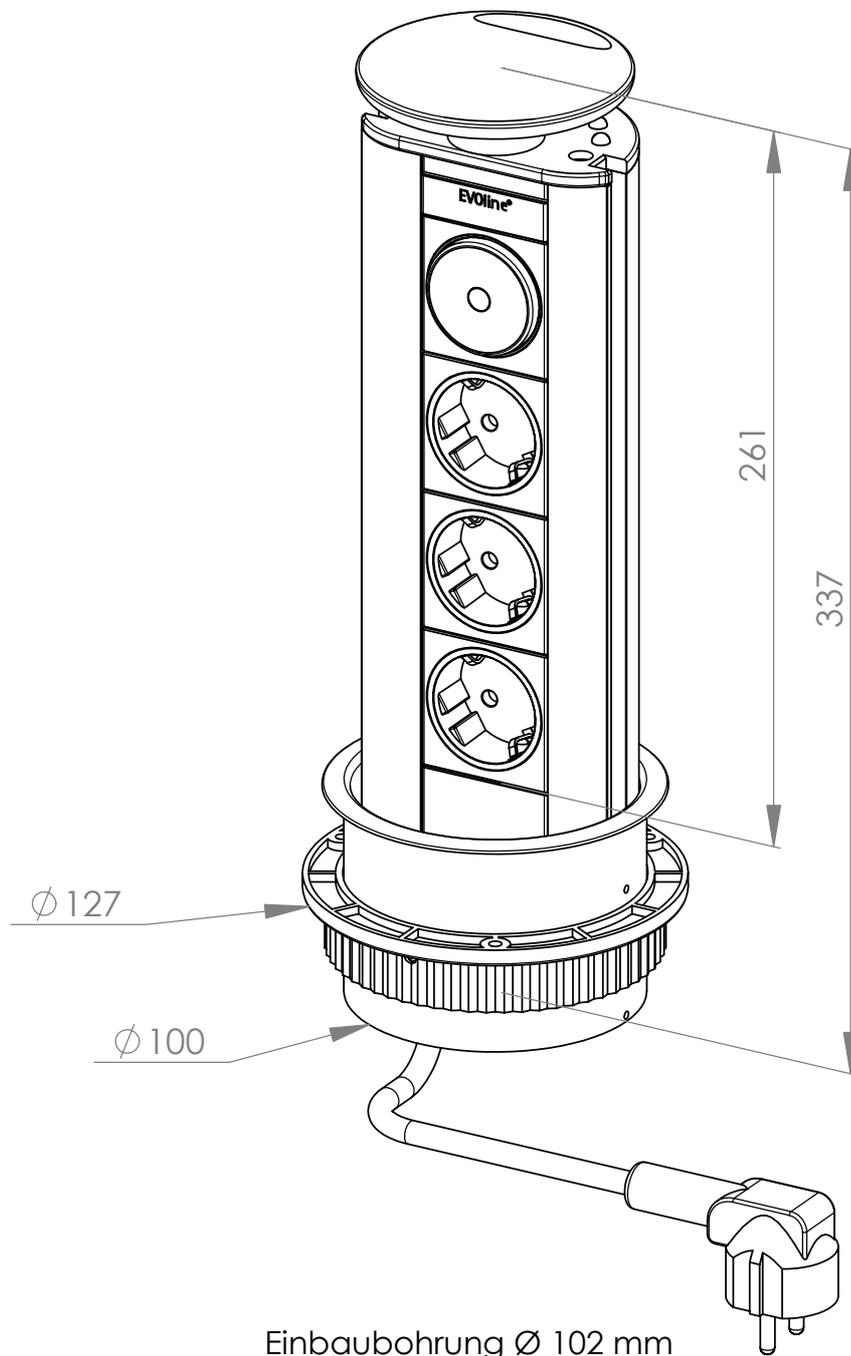
Einbaubohrung  $\varnothing 102$  mm
