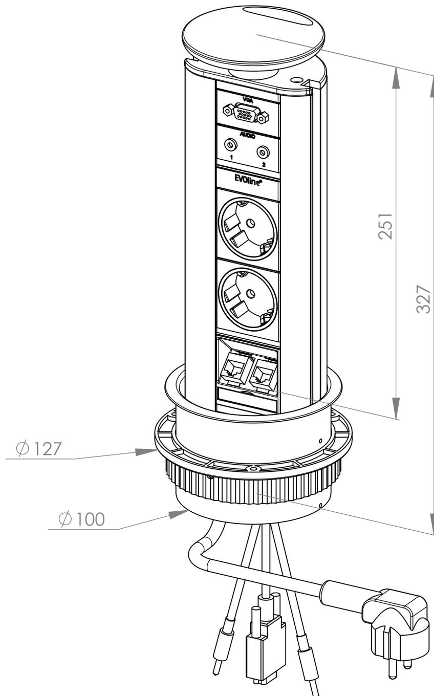
Einbaubohrung  $\phi 102$  mm
